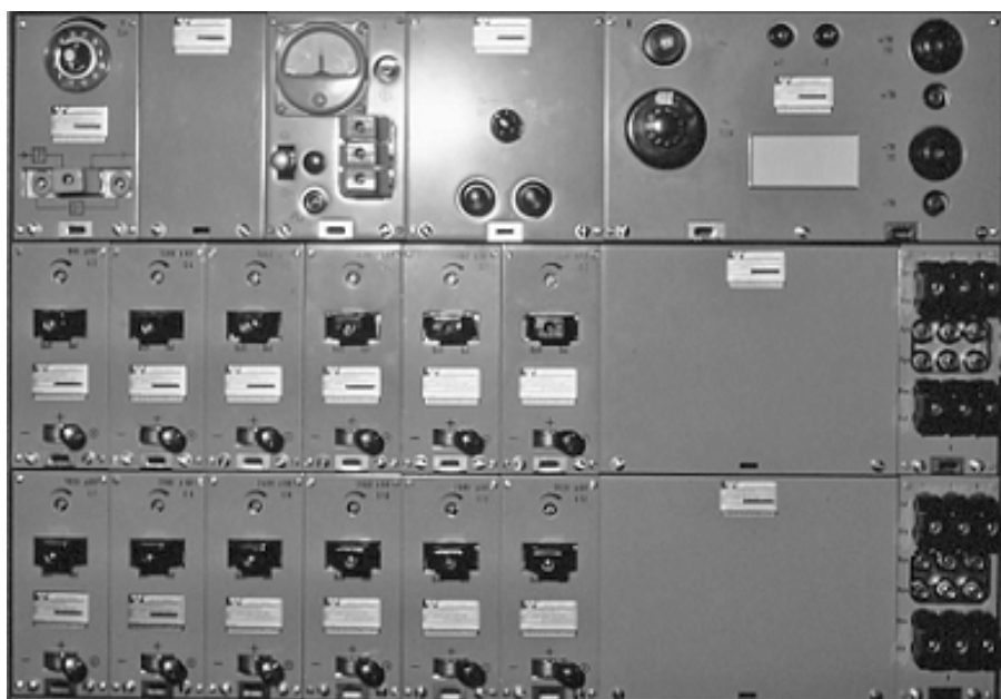
Tontelegrafutrustning WT100 Sändaram med 12 kanaler
