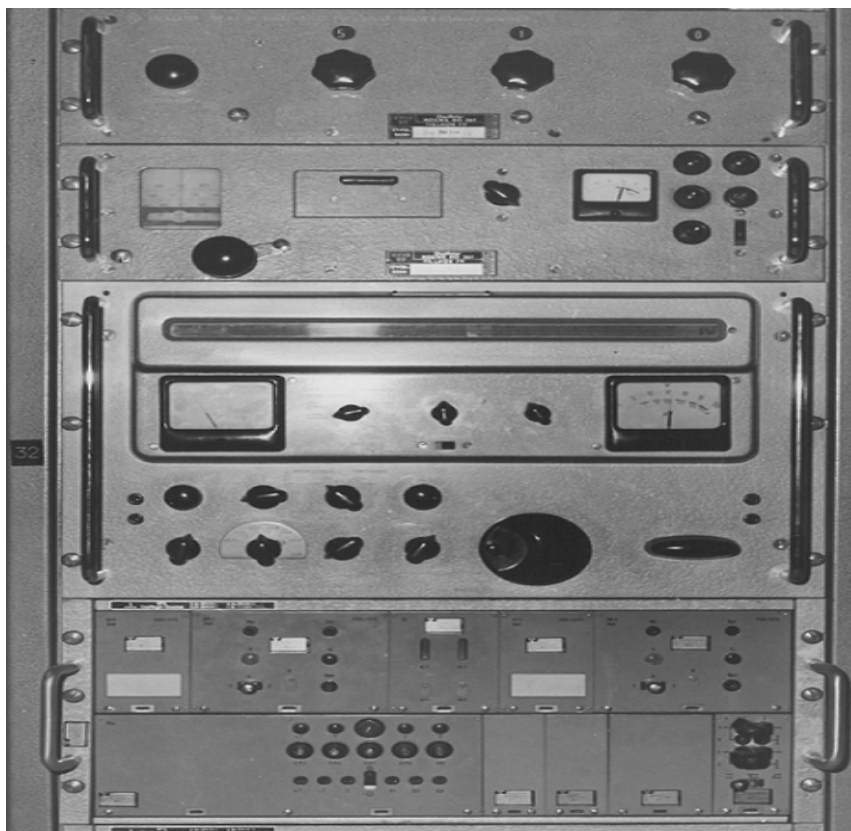
Radiomottagare EK11 med Oscillator NO261 och Demodulator WTK340
