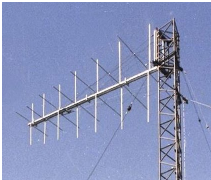
Krysslogantenn 25 – 30 MHz 10 kW
